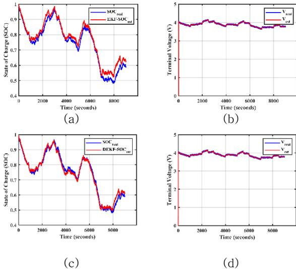
Fig. 2 Voltage bias scenario estimations (a) EKF-SOC; (b) EKF-voltage (c) DEKF-SOC (d) DEKF-voltage
